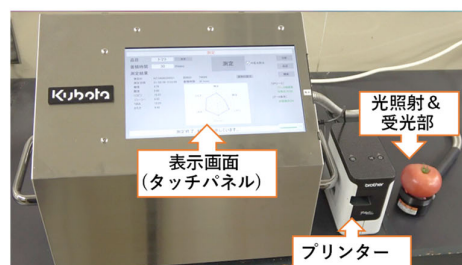
おいしさセンシングの卓上型装置（試作機）
