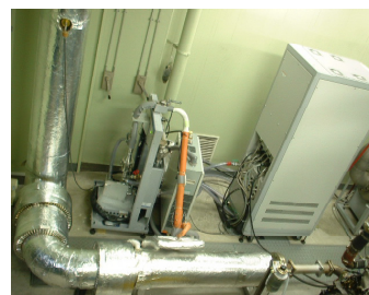
図 13 排出ガス中の粒子状物質を採取する装置
