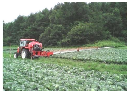
図11 ドリフト低減ブームスプレーヤによる散布作業
