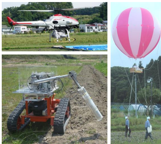
図1. ガンマ線の強度を測定する装置を乗せた無人ヘリ（左上）、ラジコン移動車（左下）、気球（右）
