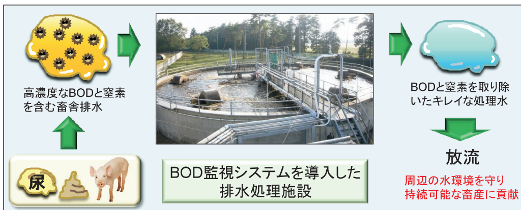
図 2 BOD 監視システムで運転制御された排水処理施設
