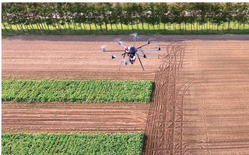
センシング技術を利用したドローンによる生育調査
