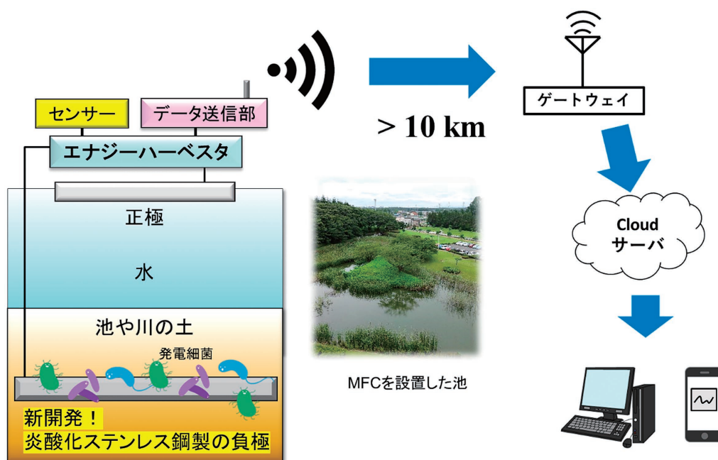
図 微生物燃料電池を電源とした自立駆動型の環境モニタリング装置
