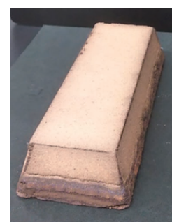
図2 稲わら粉末から試作した糖備蓄のための「糖の延べ棒」
