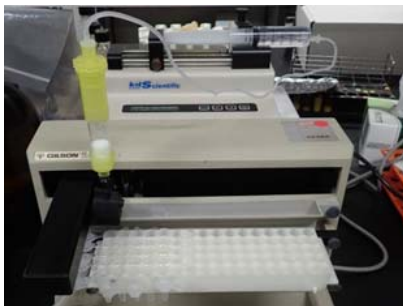
図3 試作したセルラーゼ固定化シルクを用いたリアクター
