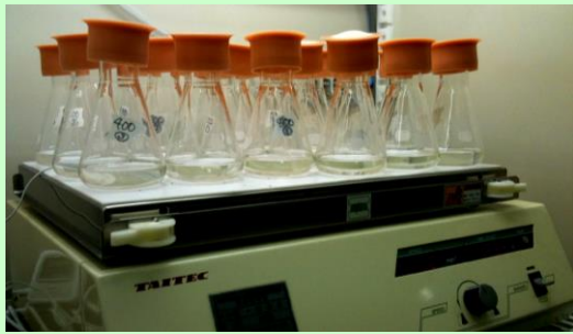
三角フラスコを用いた従来の試験法
