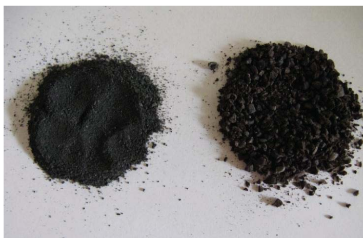
図1 茶殻またはコーヒー粕から製造した殺菌用資材 左は茶殻由来、右はコーヒー粕由来の資材
