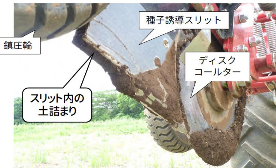
図 7-3. スリット内に土が詰まり、種子が落ちなくなった状態
