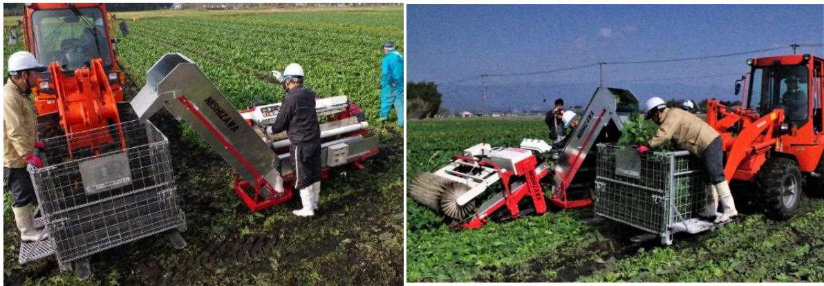
写真4 メッシュコンテナ・ベルトコンベア方式でのホウレンソウの収穫作業 収穫物を収穫機後方に取り付けたベルトコンベアユニットで上部へ送り出し、メッシュコンテナを搭載したホイールローダーで受け取ります。
