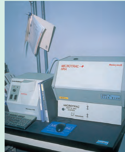
粒度分析計 小麦粉・大麦粉の粉の大きさを測定できます。
