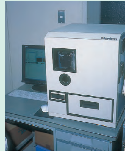
小麦/大麦粒測定器 小麦、大麦の穀粒の大きさや水分を迅速に測定できます。
