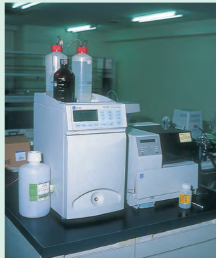
イオンクロマトグラフ 環境水中の無機イオン類を、分離・定量できます。
