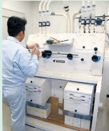
小麦製粉試験機(テストミル) 加工適性などの調査のため、数kg程度の製粉ができます。
