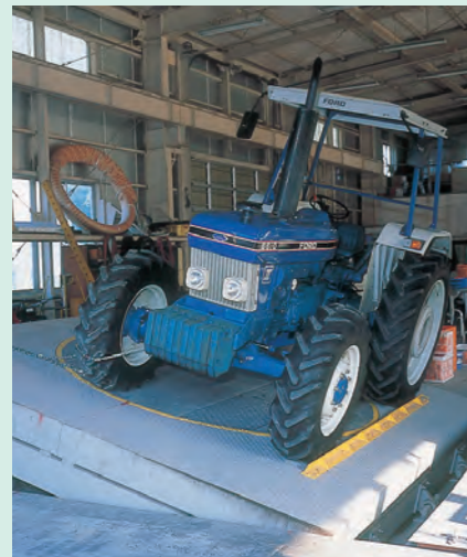
傾斜地車両特性解析装置 傾斜地における作業性を解析できます。
