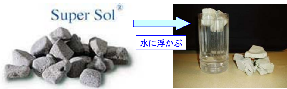
写真3 浮かぶ資材の例(ガラスリサイクル発泡資材:スーパーソル)
