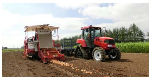
キャベツの自動収穫とコンテナの自動運搬 タマネギの自動収穫とトラクタの自動伴走収納 フォークリフトによるコンテナの自動積載と運搬
