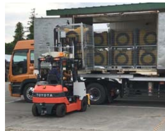
キャベツの自動収穫とコンテナの自動運搬 タマネギの自動収穫とトラクタの自動伴走収納 フォークリフトによるコンテナの自動積載と運搬
