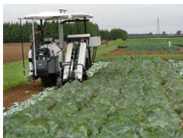
キャベツの自動収穫とコンテナの自動運搬 タマネギの自動収穫とトラクタの自動伴走収納 フォークリフトによるコンテナの自動積載と運搬
