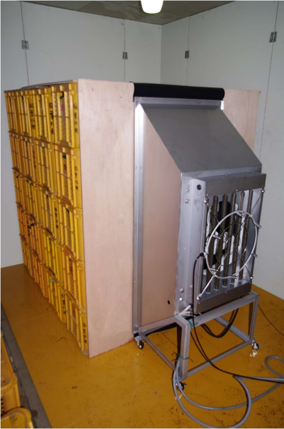
写真1 プレハブ冷蔵庫内の小型蒸熱処理防除装置
