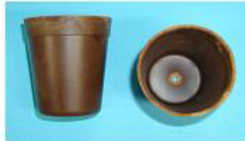
射出成形処理で作成した育苗ポット
