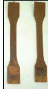
射出成形処理で作成した強度測定用の試料
