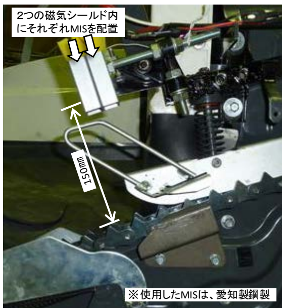
図4 MIS の設置状況
