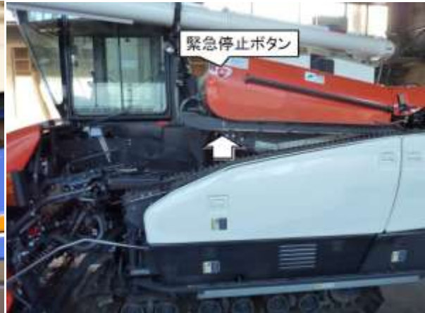
図10 B-3 型(通常作業型:挟やく桿開放式) (こぎ胴カバー及び挟やく桿が開放した状態)
