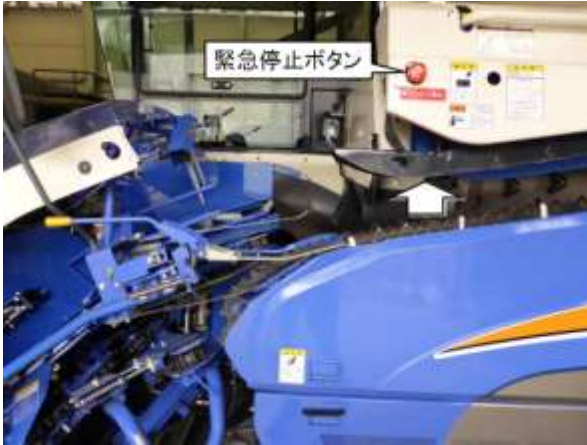
図9 A-3 型(通常作業型:こぎ胴カバー開放式) (こぎ胴カバー及び挟やく桿が開放した状態)
