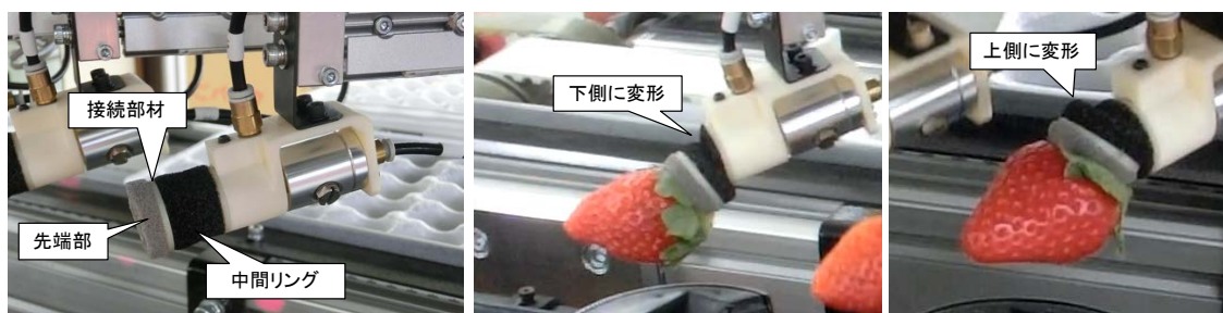
図5 吸着管先端の構成と中間リングの変形
