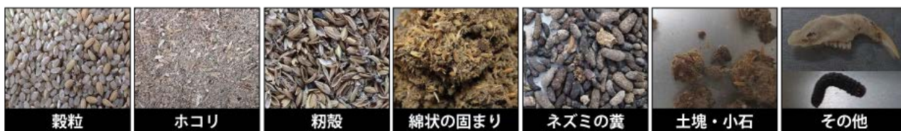
図2 分類した機内残留物サンプルの例
