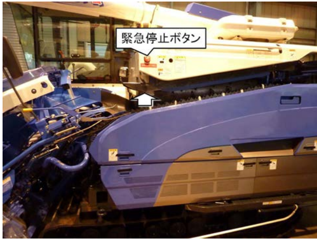
図12 通常作業型(こぎ胴カバー開放式) (こぎ胴カバーが開放した状態)
