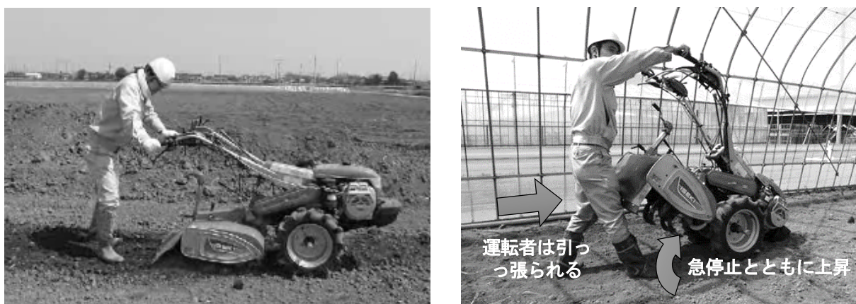
図 通常の作業状態(左)とダッシング後に急停止した時の再現(右) (通常はロータリと足が離れているが、急停止後はロータリと足が接近する)
