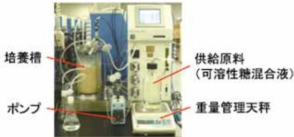
図7 連続フィード培養装置
