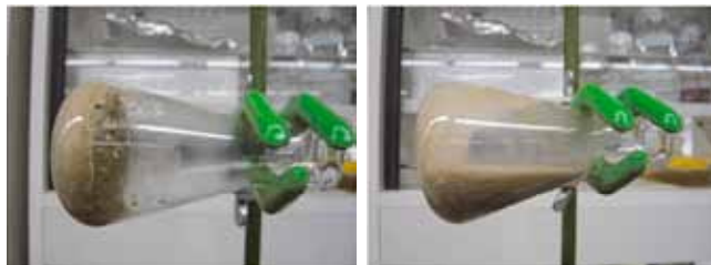
図4 バレイショ磨碎物の繊維質分解酵素処理による粘性低下
