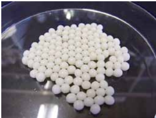
図10 光硬化性樹脂で作成した固定化酵母担体
