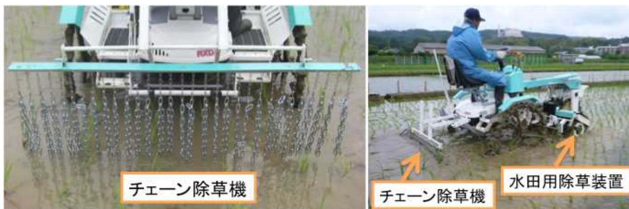
図6 チェーン除草機と水田用除草装置との併用
