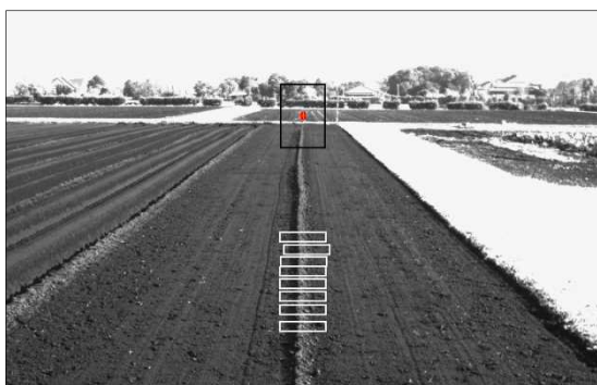
図9 直進アシスト機能用の画像処理の例
