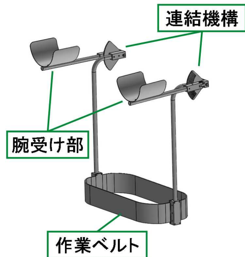
図2 腕上げ作業補助器具の構造
