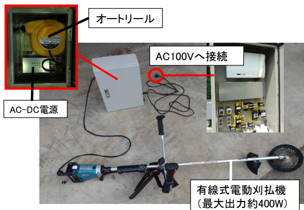
図9 試作した有線式電動刈払機
