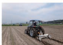
②暗渠施工位置を弾丸暗渠などで破碎し浅層暗渠施工器にかかる牽引抵抗を低減させます。
