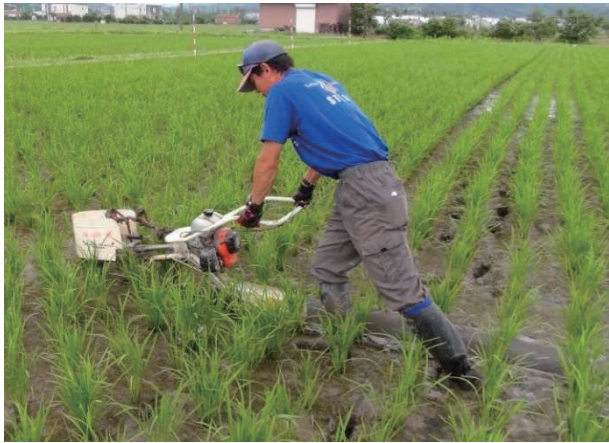
図 14 現地試験における溝切りの様子（左：慣行機、右：開発機、ともに現地④）
