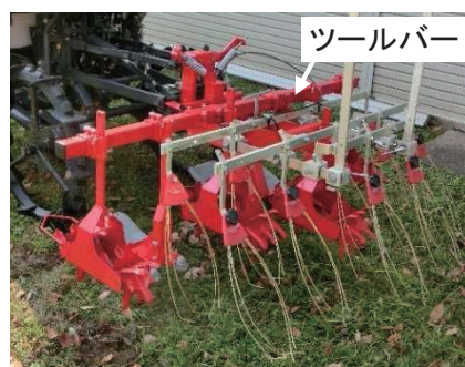
図9 除草機 (M社 LVW-6 を5条に改造)
