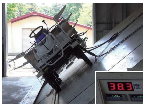
図 12 静的横転倒角の計測の様子(田植機装着時)
