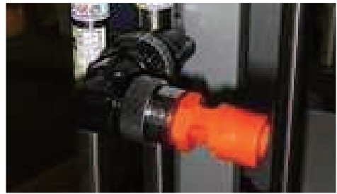
写真3 圧縮エア吐出ノズル
