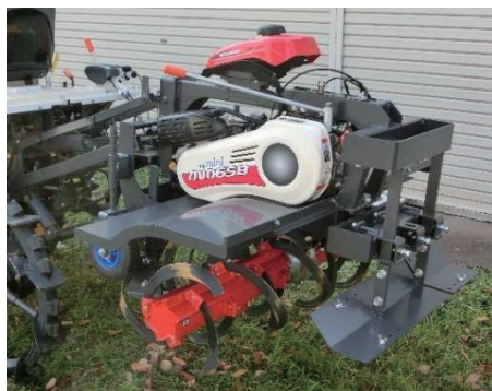
図4 耕うん機 (M社 MM658 を改造)
