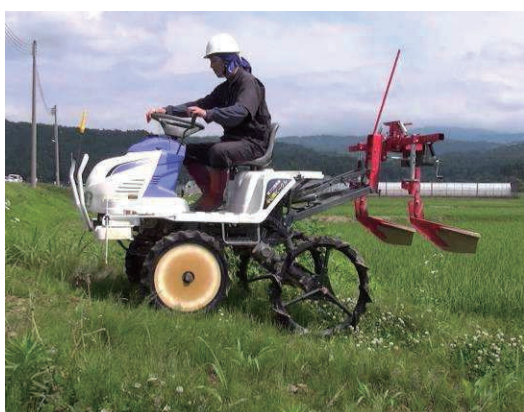
図 11 後輪昇降機構を利用した傾斜地走行の様子(溝切機装着時)
