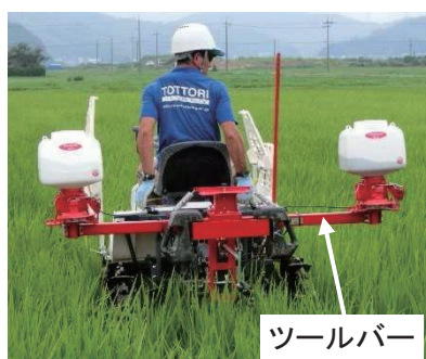
図8 粒剤散布機（電動式） (Y社 EG10K を改造)
