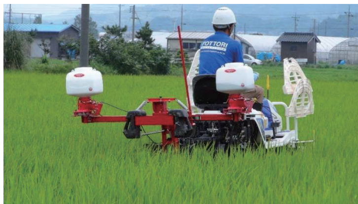
図 15 現地試験における肥料・薬剤散布の様子 （左上：慣行機（肥料散布）、右上：慣行機（薬剤散布）、中央：開発機（同時散布）、ともに現地④）
