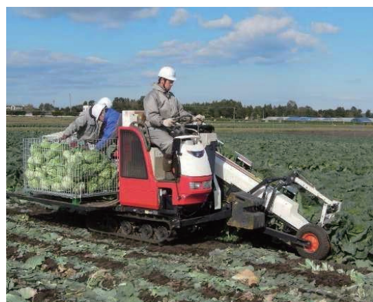
図2 新型キャベツ収穫機
