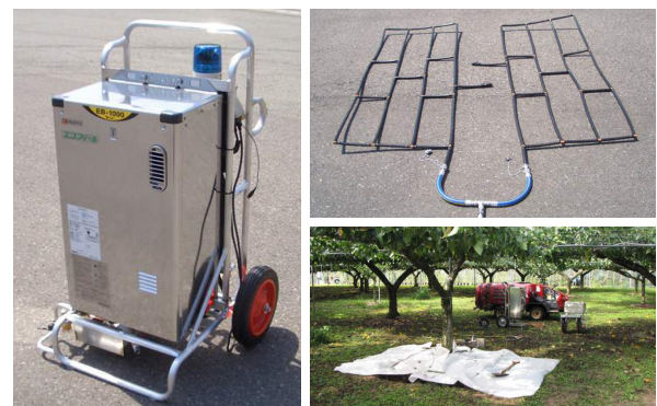
図1 左：温水点滴処理機（本体）、右上：点滴チューブ、右下：ナシ園で温水治療を実施している様子
