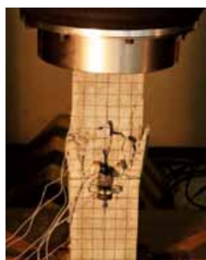
■水路継目の破壊実験
