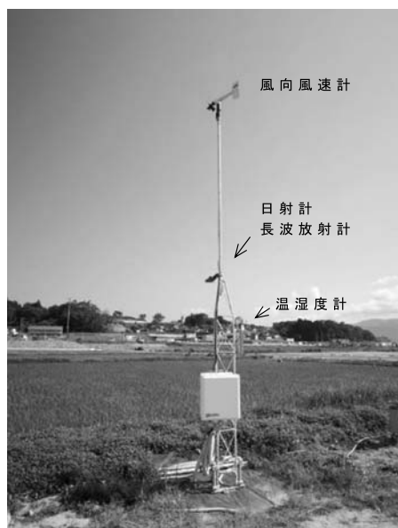
写真2 気象モニタリングシステムの外観
