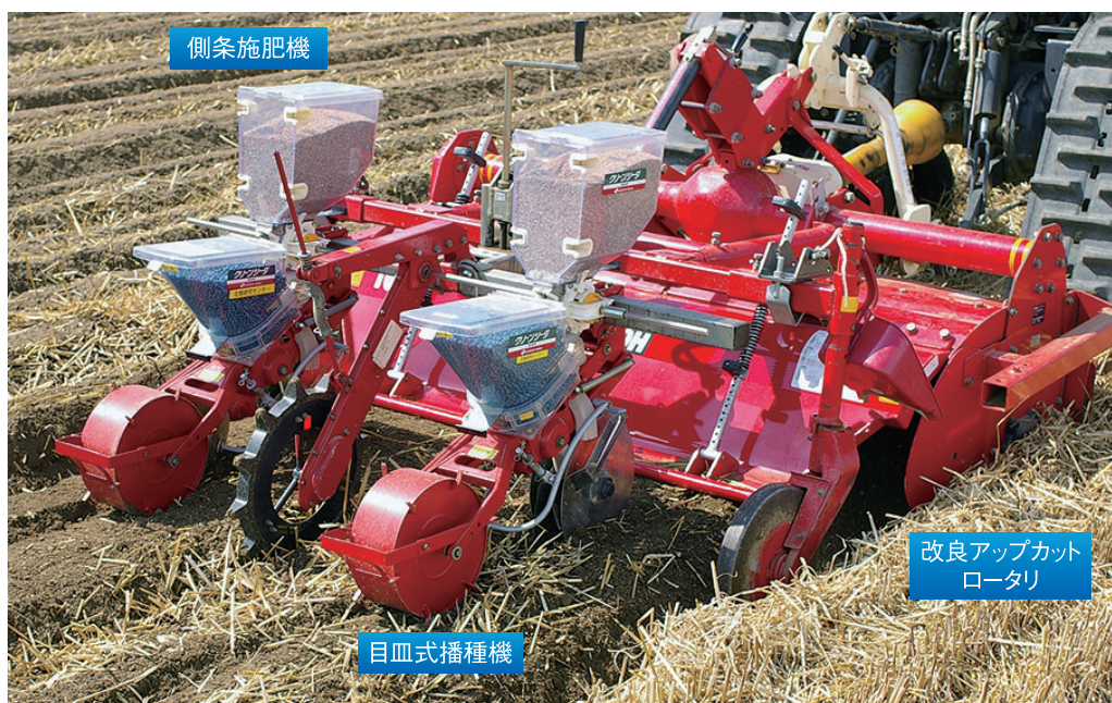
図32 耕うん同時畝立て播種機の構成
