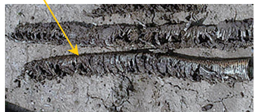
掘削深さを深くしすぎると、暗渠を傷つけるので注意して下さい。
