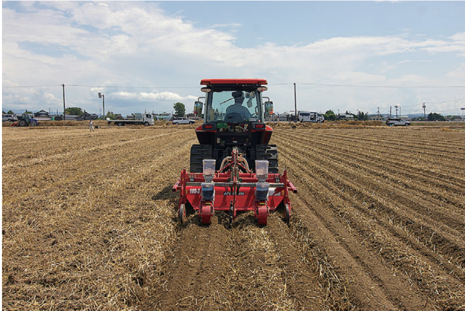
図33 耕うん同時畝立て播種の畝状況（播種条ごとの畝立ての耕うん爪配列）
