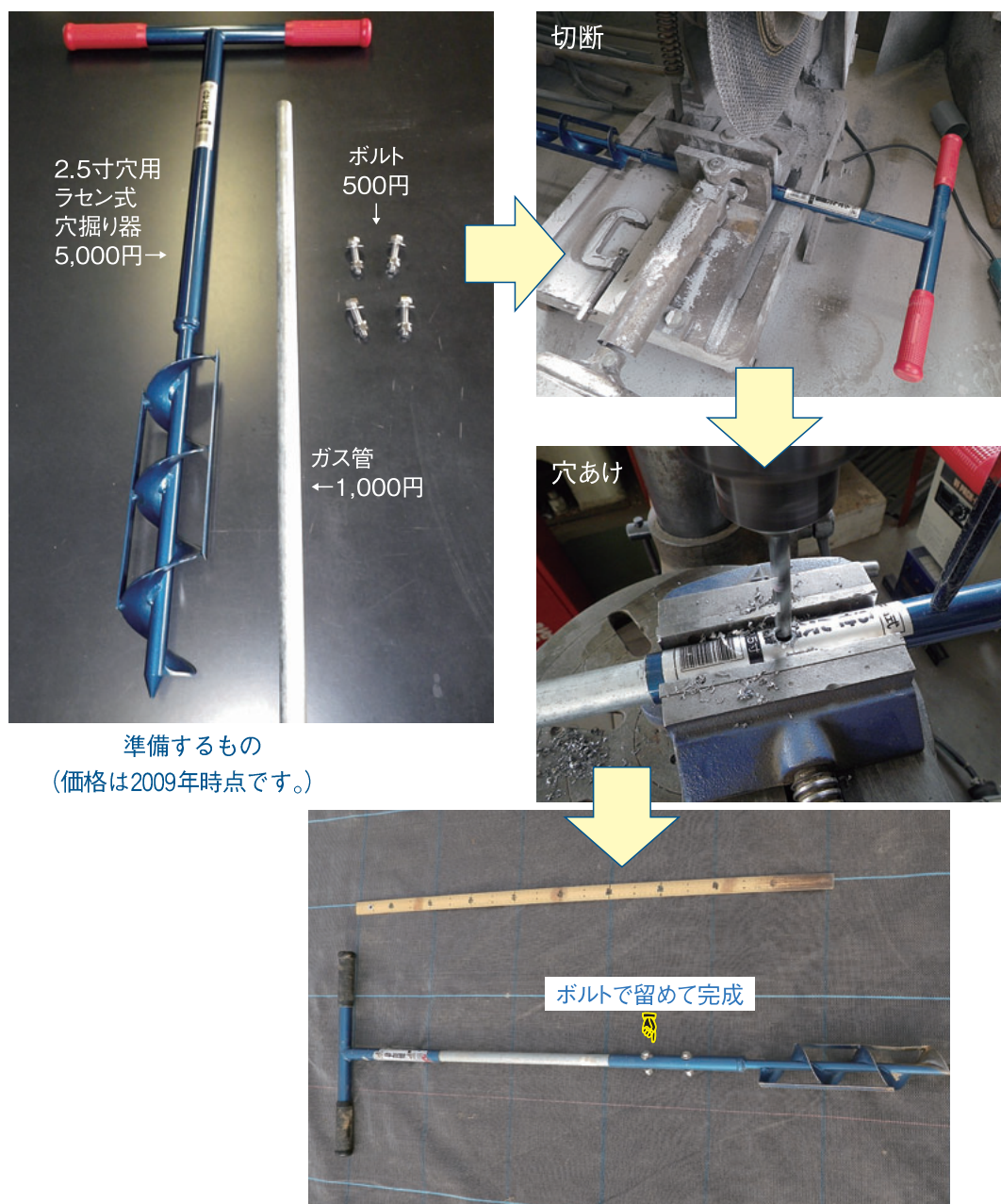
図48 長さ1 mの穴掘り器の製作に必要な部品と作り方
