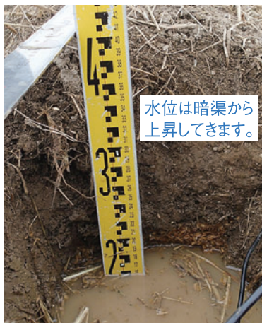
図38 地下灌漑時の圃場の断面
