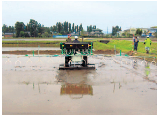
種籾を空気搬送で32条分（作業幅9.6m）を一度に播種を行うエアアシスト水稻条播機
