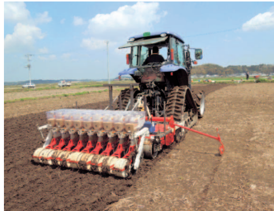
図6-2)-(1)-5 ロータリシーダによる播種作業
