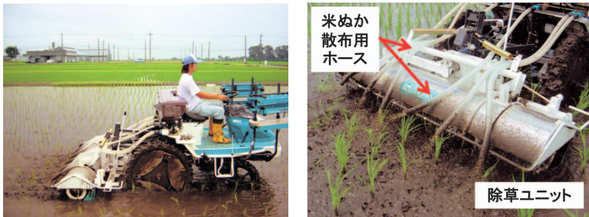
図6-2）-(2)-1 高精度水田用除草機による機械除草同時米ぬか散布作業
