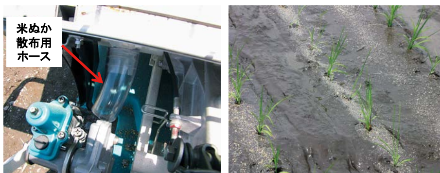
図2 田植ユニットの改良 (左) と移植同時米ぬか散布の状況 (右)
