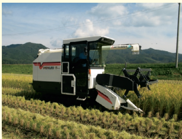
4tトラックにも搭載可能で、幅の狭い農道や区画整備が進んでいない地域へも導入できる小型汎用コンバイン
