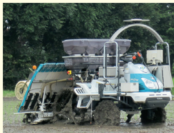
完全無人で施肥・移植・除草剤散布を行う田植えロボット
