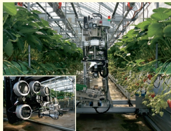
LED照明とCCDカメラによる画像処理ののち、熟したイチゴのみを収穫するイチゴ収穫ロボット
