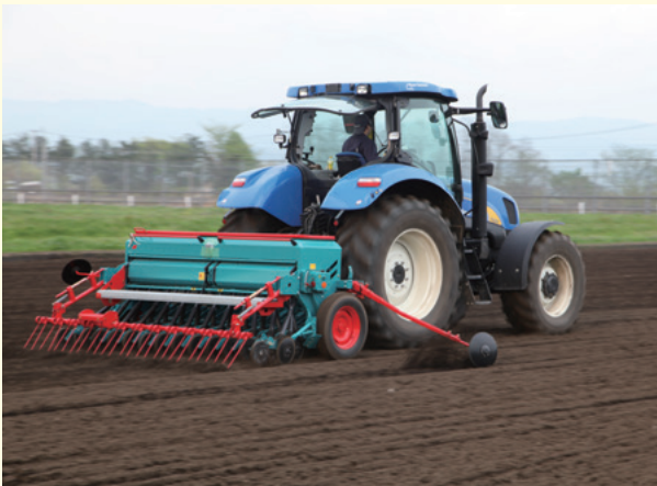
稲、麦両作物に利用できて高効率な播種機(グレーンドリル)を用いた水稲の乾田直播作業体系
