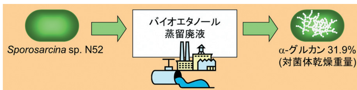
図1. バイオエタノール蒸留廃液中に含まれる細胞壁由来単糖の \alpha -グルカンへの変換
