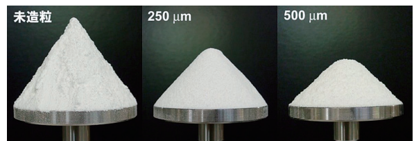
図1 造粒による粉末の安息角変化
