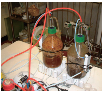
図2 尿の浄化処理からのガス発生量測定試験装置
