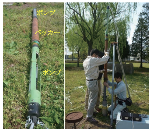
写真1 作成した揚水装置（左）と、井戸に挿入する様子（右）
