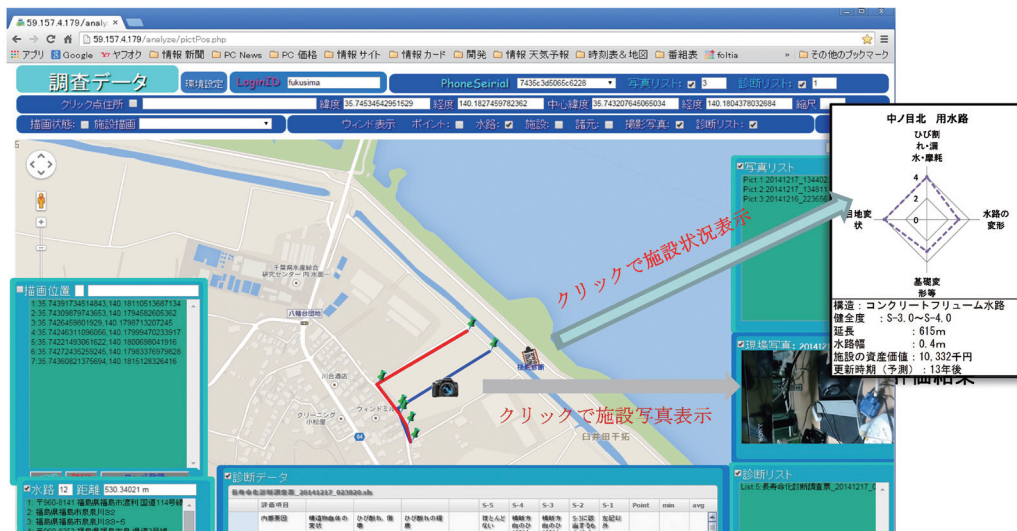
図3 PC上の地図情報とリンクした施設の状況分析・情報管理システム
