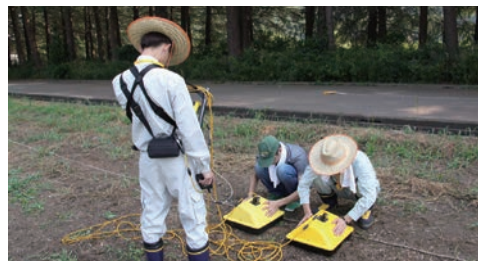
物理探査による地盤構造の調査 (技術移転センター 移転推進室交流チーム長 齋藤仁)
