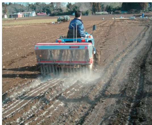
写真8 ライムソウーによる転炉スラグの散布
