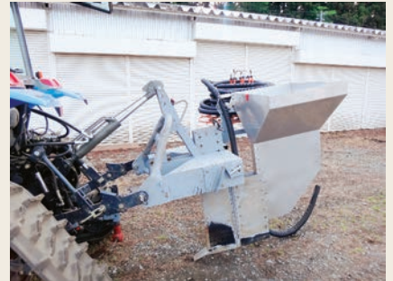
簡易暗渠施工器
