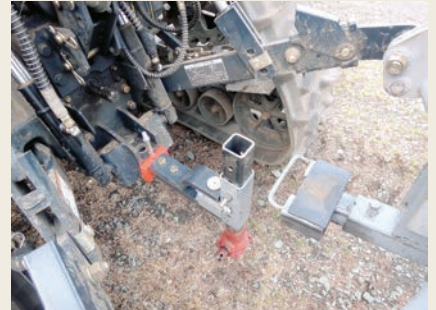
考案した掘削深度安定化装置
