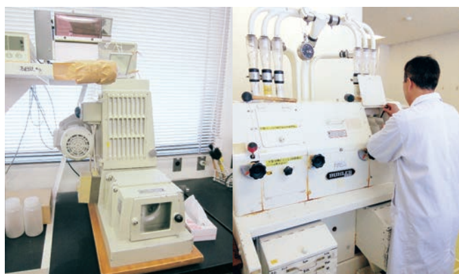
写真/東北農研でコムギの品種開発に利用している試験用製粉機 左: 100g程度の穀粒から利用できるブラベンダー社製製粉機 右: 1kg程度の穀粒から利用できるビューラー社製製粉機
