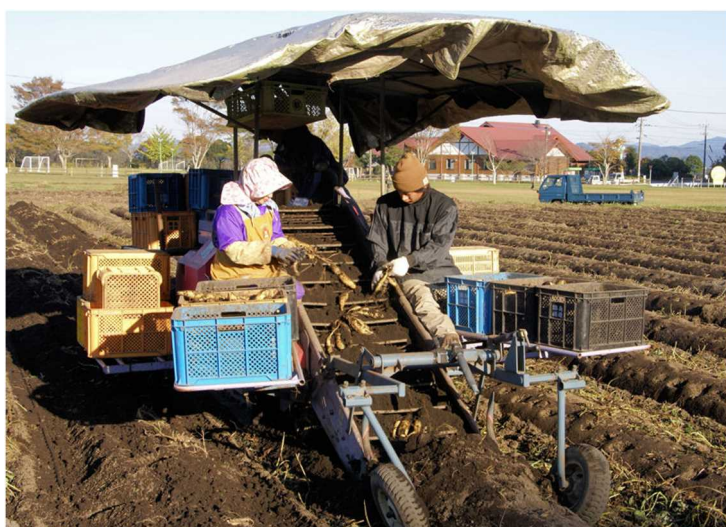
サツマイモ収穫 収穫機「ポテカルゴ」は中高平高畦にも適合
