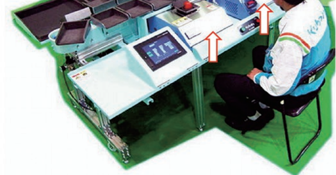
図1 小規模ラインに組込まれた拡散反射非接触測定方式の機器(手前中央に2台:赤い矢印参照) 写真提供:(株)クボタ
