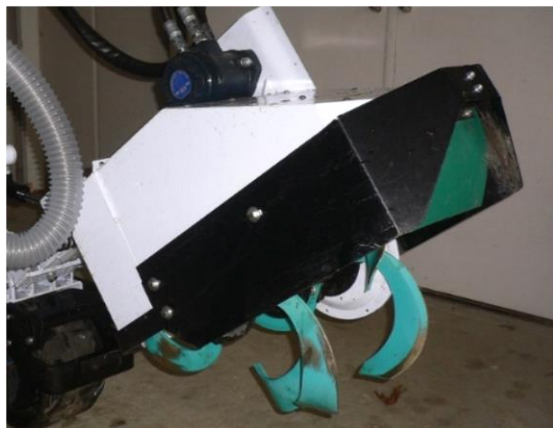
乗用型茶園管理機に装着可能な ロータリ式耕うんアタッチメント (写真提供:滋賀県農業技術振興センター)
