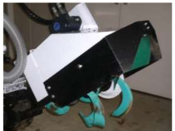
乗用型茶園管理機に装着可能な ロータリ式耕うんアタッチメント (写真提供:滋賀県農業技術振興センター)
