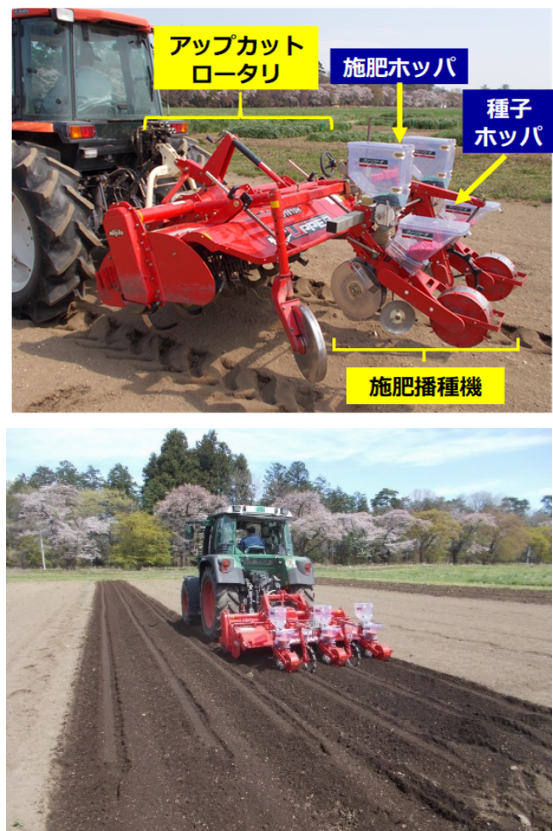
図3-4. 耕うん同時畝立て播種機の構造(上)および3条用の耕うん同時畝立て播種機(下)
