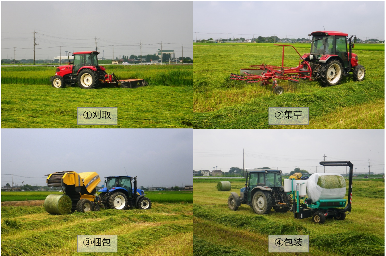
写真2-1. 牧草収穫機械体系によるWCS用稲1番草の収穫調製作業（8月上旬）
