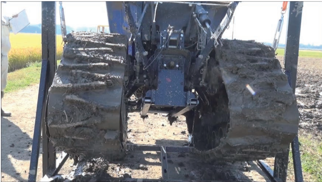
剥離した付着土の大部分は装置近傍に落下するため清掃も楽
