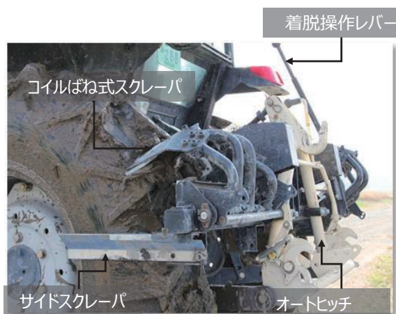
スクレーパ式の除泥装置
