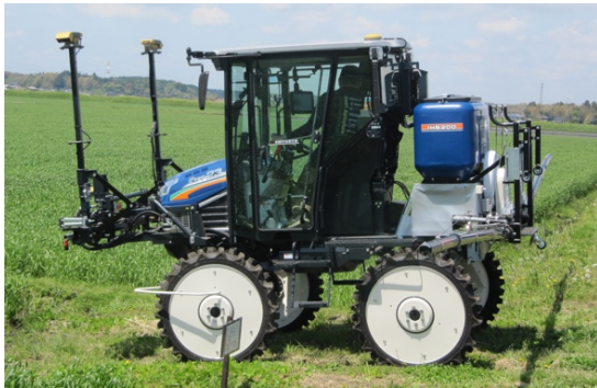
図4 ISOBUS 対応を行った可変散布機
