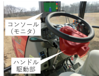
図7 自動操舵補助装置の装着例 (東京計器製「AG-GEAR3」)
