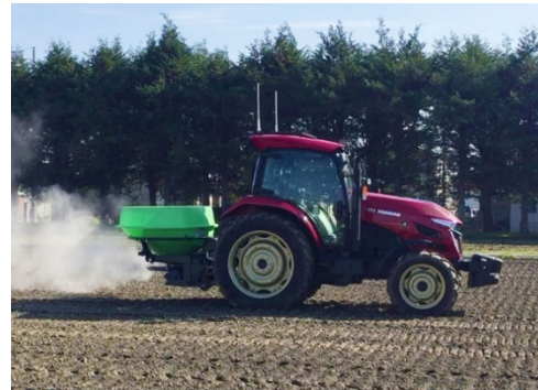
図5 通信仕様を実装したロボトラの施肥作業
