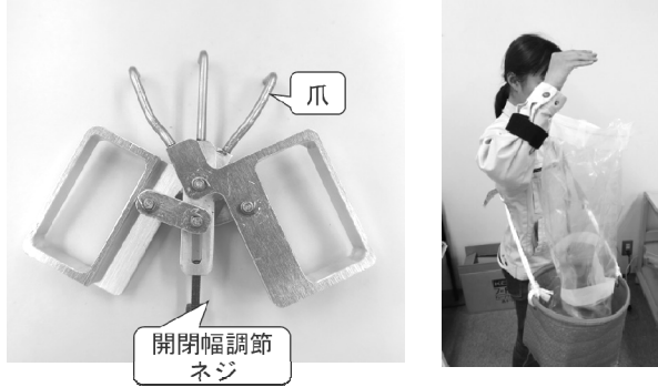
図2 左：花蕾採取機ハサミ熊手式 右：收集器
