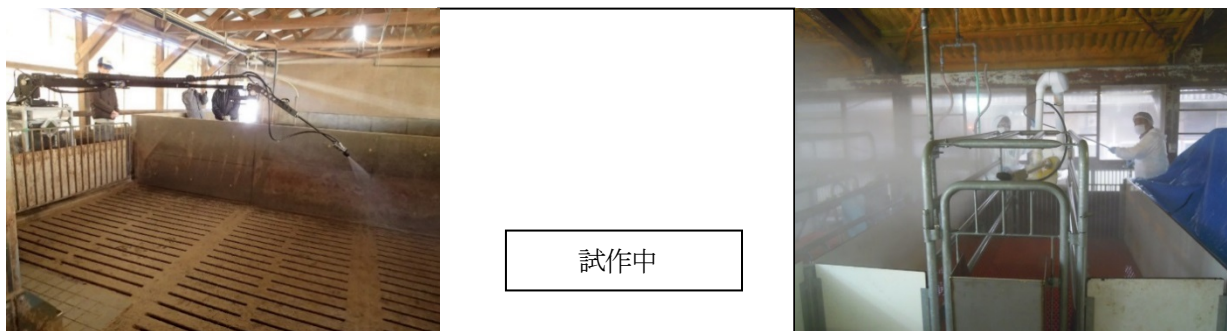
図 2 各 2 次試作機による洗浄試験の様子 (左から高機能型、低価格重視型、分娩豚舎用)
