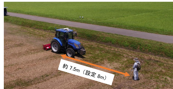
図4 実証試験における人認識による自動停止
