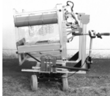
図2 花蕾採取機自走式2号機 (左:上昇時 右:下降時)
