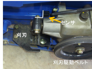
図2 刈刃詰まり検知センサ
