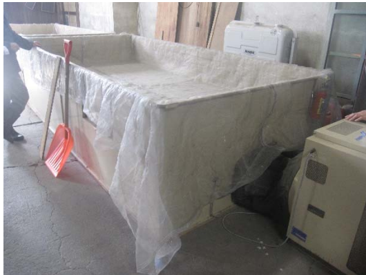
図3 寒冷紗を敷設した平型乾燥機 (アマランサス用)
