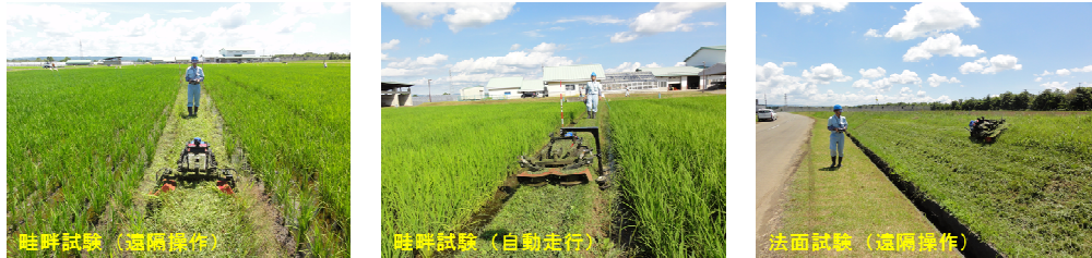
図2 高機動畦畔草刈機試作3号機(改)による現地試験の様子
