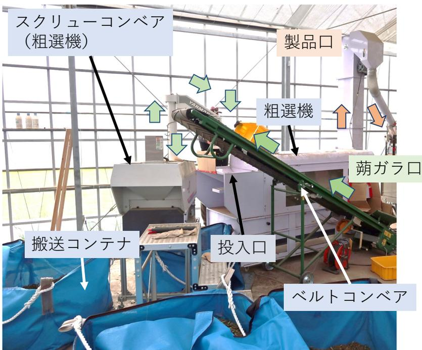
蒴ガラ口から出てきた蒴果が再び投入口へ戻るようにコンベアを配置。
