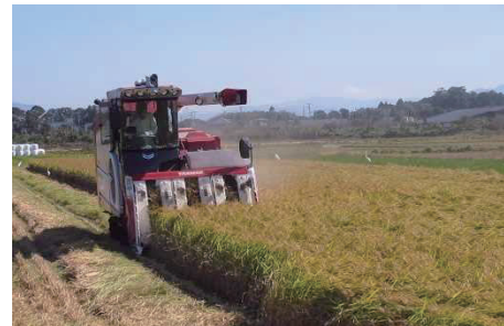
図5 レーザ距離センサを搭載したコンバインによる収穫作業
