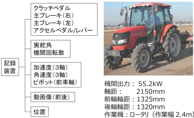
図3 試作機の構成と搭載トラクター
