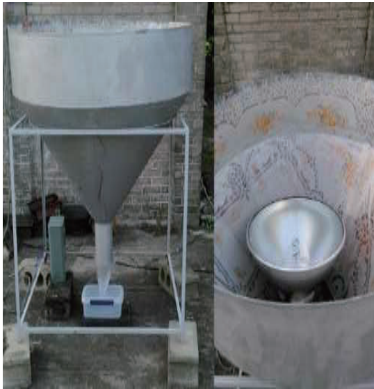
図1 サーチライトトラップの外観
