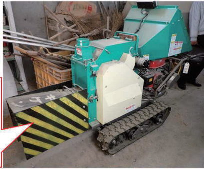
図1 事故発生後に使用者側で機械に対する本質的・工学的安全対策が取られた事例
