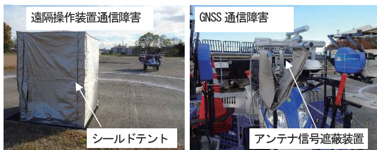
図3 通信障害の機能確認試験
