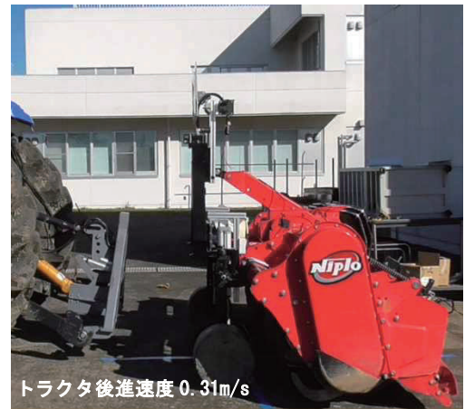
図3 作業機の着脱試験の様子
