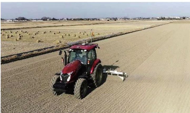
図3 無人トラクタによる自動均平作業
